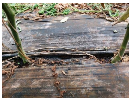
Figure 8 : photographie d'une déchirure observée sur une modalité de paillage biodégradable durant la culture
