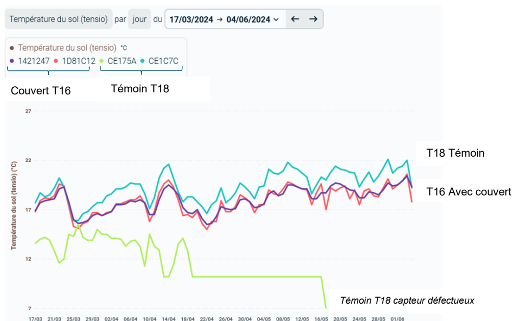
Fig 9 : Températures du sol mesuré par les sondes Weenat dans les 2 modalités
