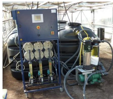
Figure 9 : Dispositif pilote d'électrolyse évalué par l'APREL en 2011
