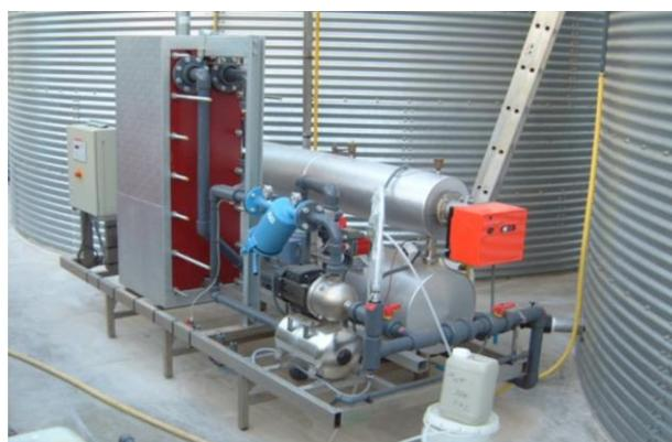
Figure 6 : Dispositif de thermodésinfection évalué par l'APREL entre 2003 et 2005
