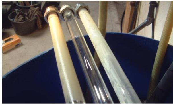
**Figure 5 : Essais 2004-2006, manque d'efficacité du système de nettoyage des lampes. La désinfection est insuffisante.**
